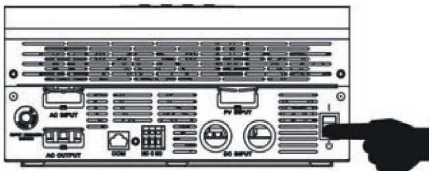
После того как устройство было надлежащим образом установлено, а также к нему были соответствующим образом подключены аккумуляторные батареи, просто нажмите на кнопку On/Off (Вкл/Выкл), расположенную в нижней части корпуса, чтобы включить устройство.
