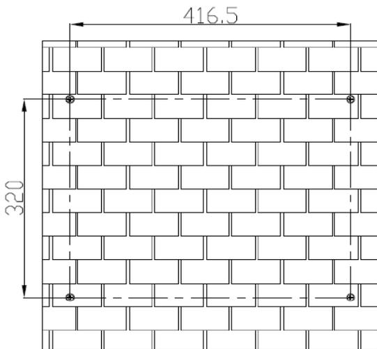
2. Поставьте инвертор на твердую поверхность и наметьте крепежные отверстия четырьмя шурупами
