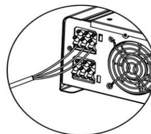
**ПРЕДОСТЕРЕЖЕНИЕ:** Нагрузку можно подключать только к коннектору выхода переменного тока. НЕ ПОДКЛЮЧАЙТЕ электросеть 220 В к коннектору выхода переменного тока.
