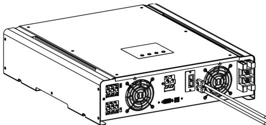
Для соединения через SNMP или Modbus карту используйте стандартный RJ-45 кабель.
