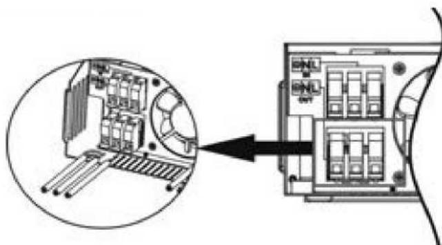
8. Проверить, надежно ли подключены провода.
